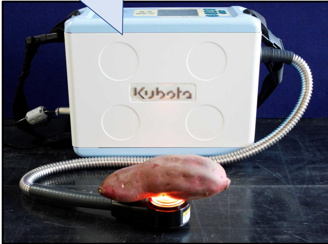
携帯型近赤外分光装置 フルーツセクター K-BA100R
